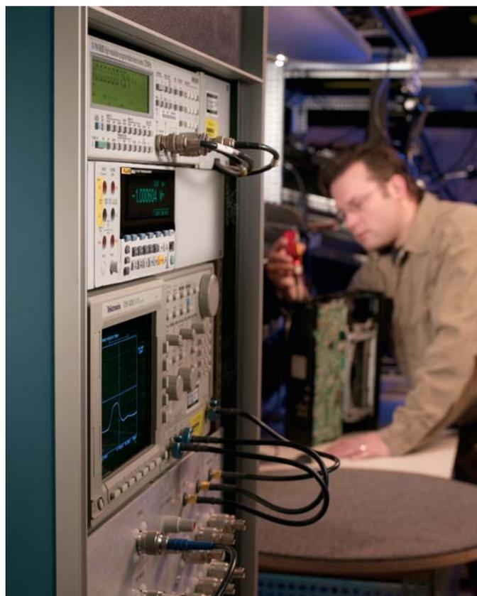
拥有专利的分隔式插孔，利用2根测试线即可进行四线电阻测量。
