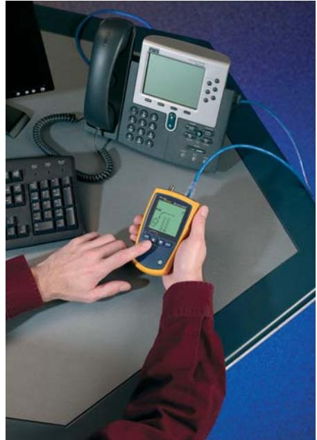
插座中的高级数据电缆(Cat 5e/6/6a)。而对于语音级电缆(Cat 3和更低类别)以及同轴电缆、安全/警报电缆和扬声器电缆，使用模拟音频模式更好。
