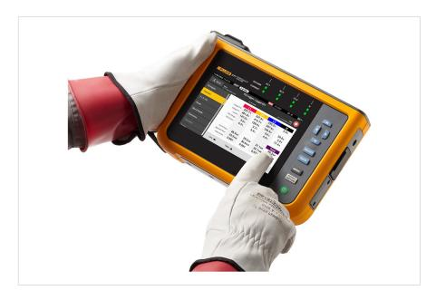
Fluke 1773 电能质量分析仪 FLUKE-1773, POWER QUALITY ANALYZER
